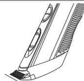
**ПРИМЕЧАНИЕ.** Указанные значения длины стрижки можно установить только в том случае, когда устройство установлено под относительно большим наклоном и опирается на поверхность режущей кромки (см. рисунок).
