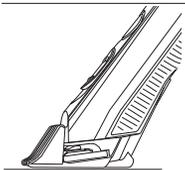
**ПРИМЕЧАНИЕ.** Указанные значения длины стрижки можно установить только в том случае, когда устройство опирается на поверхность расчески (см. рисунок).
