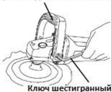
Дополнительная рукоятка поставляется в комплекте с инструментом. Рукоятка должна быть закреплена с левой и правой части редуктора. На рисунке изображена установка дополнительной рукоятки.
