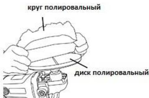
Установите полировальный диск на машину. Равномерно натяните полировальный мягкий круг на диск
