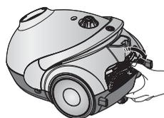
Нажмите на фиксирующую рамку в задней части корпуса, чтобы извлечь ее.
