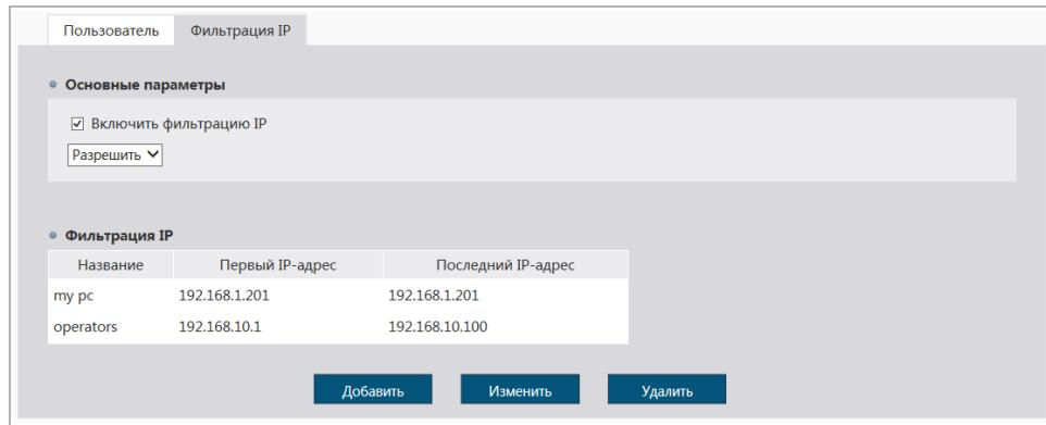
Используя настройки фильтра по IP можно ограничить доступ к IP-камере с одного или нескольких сетевых устройств.
