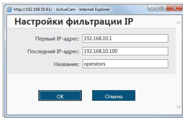
В открывшемся окне **Настройки фильтрации IP [IP Filtering Settings]** введите **Первый IP-адрес [Start IP]** диапазона и **Последний IP-адрес [End IP]**. В поле **Название [Alias]** введите название данного диапазона IP-адресов.
