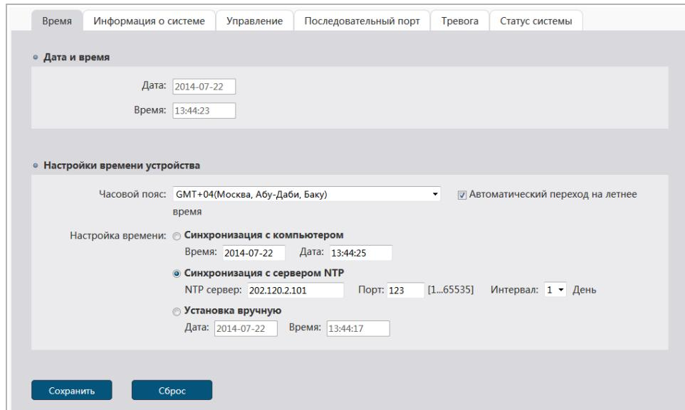
В блоке **Дата и время [Date & Time]** отображаются дата и время установленные на IP-камере.
