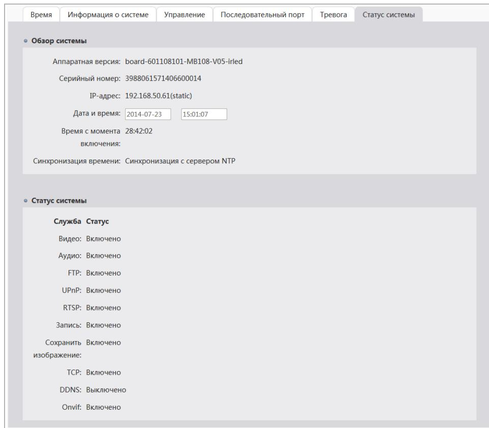
В блоке **Обзор системы[System Overview]** отображается системная информация и значение некоторых настроек IP-камеры.
