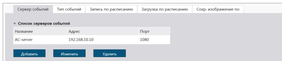
В данном меню производится настройка подключения к серверу, на который будет производится отправка сообщений (см. раздел 3.3.6.2). Для добавления нового подключения нажмите кнопку **Добавить [Add]**.
