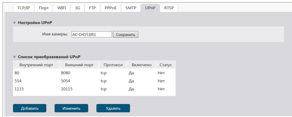
Функция Universal Plug&Play(UPnP) используется для поиска IP-камеры в локальной сети интеллектуальными системами видеонаблюдения. В блоке **Настройка UpnP [UPnP Settings]** в поле **Имя камеры [Camera name]** введите имя, которое будет отображаться при поиске данного устройства.
