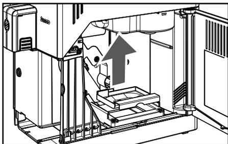
**7** Протрите внутреннее отделение машины влажной тряпкой.
