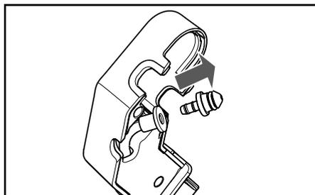
**5** Снимите трубку со штуцером.
