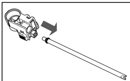
**6** Снимите штуцер с трубки.
