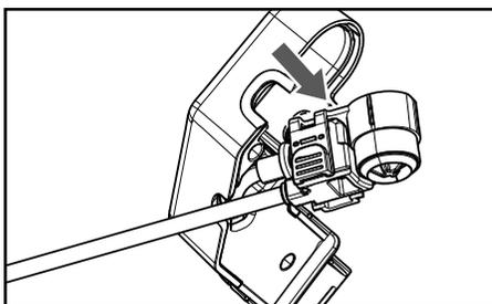
**3** Снимите нижнюю часть корпуса.
