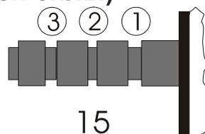
Сдвиньте петлю на нити груза антискейтинга до третьей отметки шкалы, чтобы установить компенсирующую силу антискейтинга соответствующей установленному на предприятии-изготовителе звукоснимателю. Проденьте нить в петлю проволочного суппорта (17).
