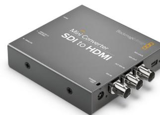
Преобразование SDI-видео в HDMI во всех SD- и HD-форматах вплоть до 1080p60. Извлечение звука из потока для вывода на HDMI-, AES/EBU- или балансные аналоговые аудиовыходы. Mini Converter SDI to HDMI — отличное решение для использования HDMI-телевизоров и видеопрокторов в качестве SDI-мониторов для работы с любыми SD- и HD-форматами по цене ниже Ultra HD-модели.
