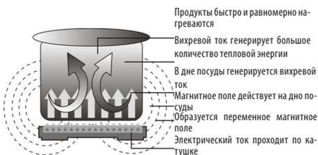
В индукционной плитке используется технология электромагнитной индукции. Электрический ток проходит по катушке, находящейся в плитке, и генерирует переменное магнитное поле. Пронизывая дно посуды, магнитное поле создает вихревой ток, в результате чего образуется большое количество тепловой энергии.
