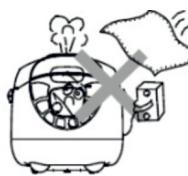
Не закрывайте отверстия для выхода пара кухонным полотенцем и другими предметами, чтобы избежать деформации и изменения цвета прибора.
