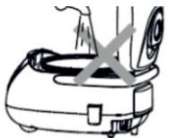
Запрещается погружать прибор в воду или другие жидкости. Если вы не используете прибор, отключите его от электросети.
