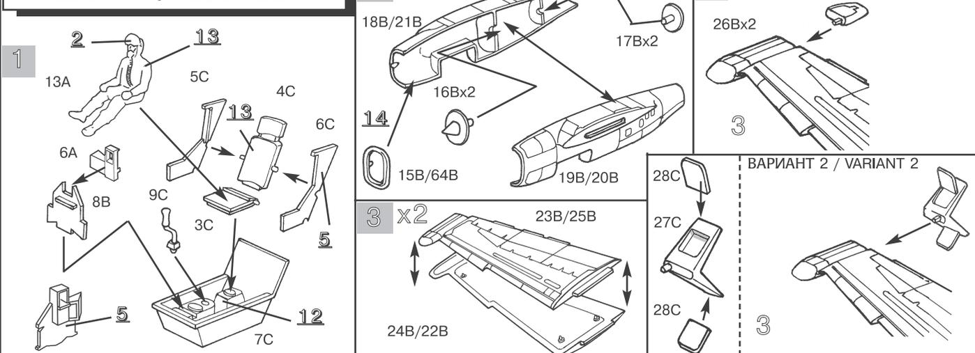
**5** В носовую часть фюзеляжа для обеспечения устойчивости модели надо положить груз (можно пластилин) весом не менее 7 грамм.
