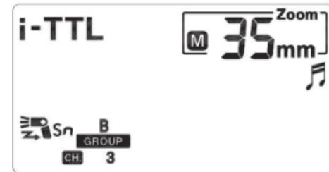
Способ установки: удерживая кнопку **High-speed/Rear-curtain** (поз.15), кнопкой **ZOOM** выберите канал (1,2,3,4). В режиме **Sc/Sn** мощность YN 500EX задается только ведущей вспышкой.
