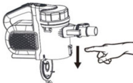
Отсоедините телескопическую трубку, если она была установлена.
