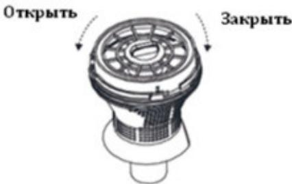
Поверните верхний входной фильтр против часовой стрелки, чтобы разобрать систему фильтров. Промойте фильтр и пластиковый фильтр-циклон холодной водой, а затем дайте им высохнуть естественным способом. Когда фильтры полностью высохнут, соберите фильтры в обратной последовательности.
