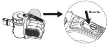
Включите пылесос переключателем на корпусе. Вы можете выбрать стандартную мощность (I) или высокую мощность (II). Когда оба переключателя выключены, пылесос выключен.
