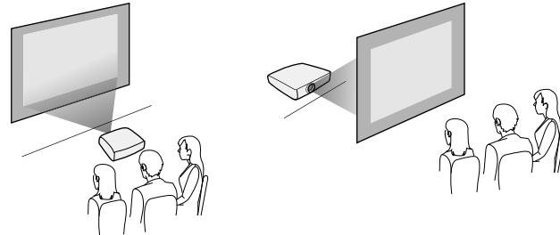
Спереди на потолке / Сзади на потолке
