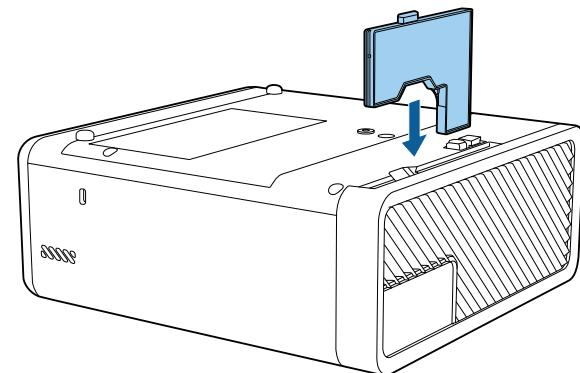
**6** Закройте крышку воздушного фильтра.
