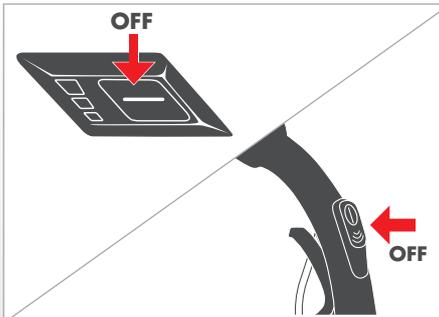
Прибор выключается повторным нажатием кнопки пуска на приборе или на пульте дистанционного управления\*. При повторном включении прибор включается сразу же на ранее выбранный уровень мощности всасывания, если он не был отсоединен от электрической сети.
