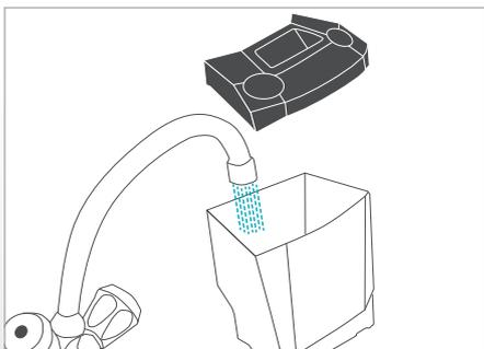
Очистка резервуара для чистой воды (только при влажной уборке)
