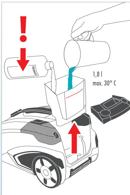
Извлечь резервуар для чистой воды из прибора. Залить в пустой резервуар для чистой воды не более 1,8 литра чистой воды (чуть теплой, не более 30 °С). Установить резервуар для чистой воды на место в прибор. Демонтаж и монтаж резервуара чистой воды описан в гл. «Очистка», раздел «Очистка резервуара для чистой воды».
