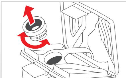
При сильном загрязнении так называемый инжектор можно снять в целях очистки, вращая уплотнение патрубка.
