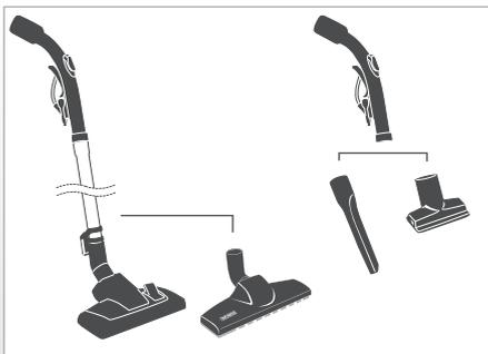
Присоединить телескопическую трубу и/или насадку, выбранную для требуемой уборки, к рукоятке всасывающего шланга. Для этого, слегка нажимая и проворачивая, вставить рукоятку в телескопическую трубу или в требуемую насадку.
