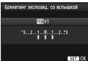
Мощность вспышки автоматически изменяется для трех последовательных кадров. Подробные сведения о FEB (Брекетинг экспозиции вспышки) см. в инструкции по эксплуатации вспышки Speedlite.
