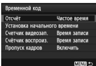
Временной код содержит информацию о времени, записываемую автоматически для синхронизации видеоизображения и звукового сопровождения во время видеосъемки. Запись временного кода выполняется каждый раз в следующих единицах: часы, минуты, секунды и кадры. В основном временной код используется во время редактирования видеозаписи. Задайте значения для временного кода на вкладке [**5: Временной код**].
