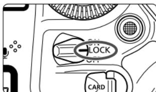
Если переключатель питания <LOCK> сдвинут в правое положение, при попытке использовать один из заблокированных элементов управления камеры в видоискателе и на ЖК-индикаторе отобразится <L>. [LOCK] будет также отображаться на экране установки функций съемки.
