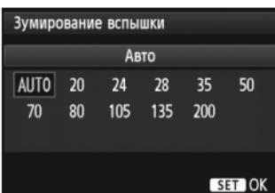
Головка вспышек Speedlite оснащена зумом, что позволяет задавать для вспышки различный угол освещения. Обычно выбирается пункт [AUTO], так чтобы камера автоматически устанавливала угол освещения, соответствующий фокусному расстоянию объектива.
