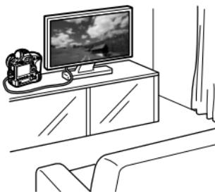
Для подсоединения камеры к телевизору пользуйтесь аудио/видеокабелем, входящим в комплект камеры, или кабелем HDMI HTC-100 (продается отдельно). После этого можно просматривать сделанные видеозаписи и фотографии на экране телевизора.
