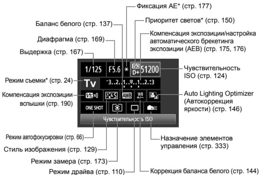
Функции, отмеченные звездочкой, невозможно установить с помощью экрана быстрой настройки.
