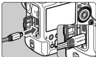
**1 Подключите прилагаемый аудио/видеокабель к камере.**
