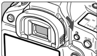
Если при съемке с автоспуском или с длительной выдержкой пользователь не смотрит в видоискатель, свет, попадающий через окуляр, может повлиять на определение экспозиции и сделать снимки более темными. Во избежание этого закройте окуляр, сдвинув рычаг шторки окуляра, как показано стрелкой.
