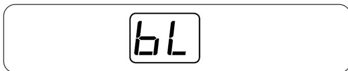
Если при начале создания петли не был опущен рычаг петли, в окне индикатора появится предупреждающий символ. Опустите рычаг петли и снова запустите машину.
