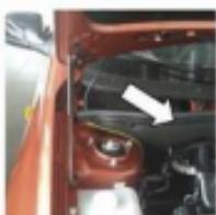
2. Установить кронштейн крыла, как показано на рисунке. Плотно прижать подгиб кронштейна к кузову и затянуть болт ключом №10 с усилием 9 Нм.
