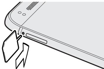
3. Нажмите кончиком инструмента внутрь отверстия до упора, чтобы выдвинуть лоток nano-SIM-карты.
