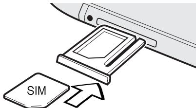
5. Задвиньте лоток с nano-SIM-картой обратно в гнездо.
