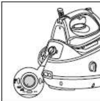
**Шаг 3.** Поверните регулятор температуры нагревания утюга на максимум, при этом должен зажечься световой индикатор нагревания утюга.
