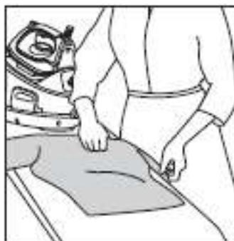
Когда погаснет световой индикатор нагревания утюга и загорится световой индикатор готовности к подаче пара, Вы можете приступать к глажке. С помощью данного прибора Вы можете гладить как в обычном режиме, так и с отпариванием.
