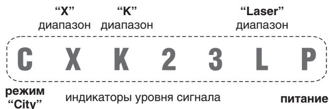
**X** - диапазону при слабом сигнале соответствуют **однотональные** звуковые сигналы **высокой частоты** и индикация на дисплее - символ **X**.
