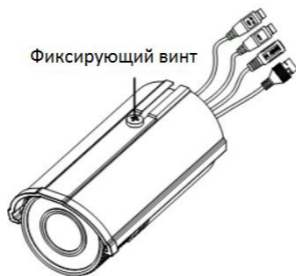
Рисунок 2-1 Удаление солнцезащитного козырька (1)
