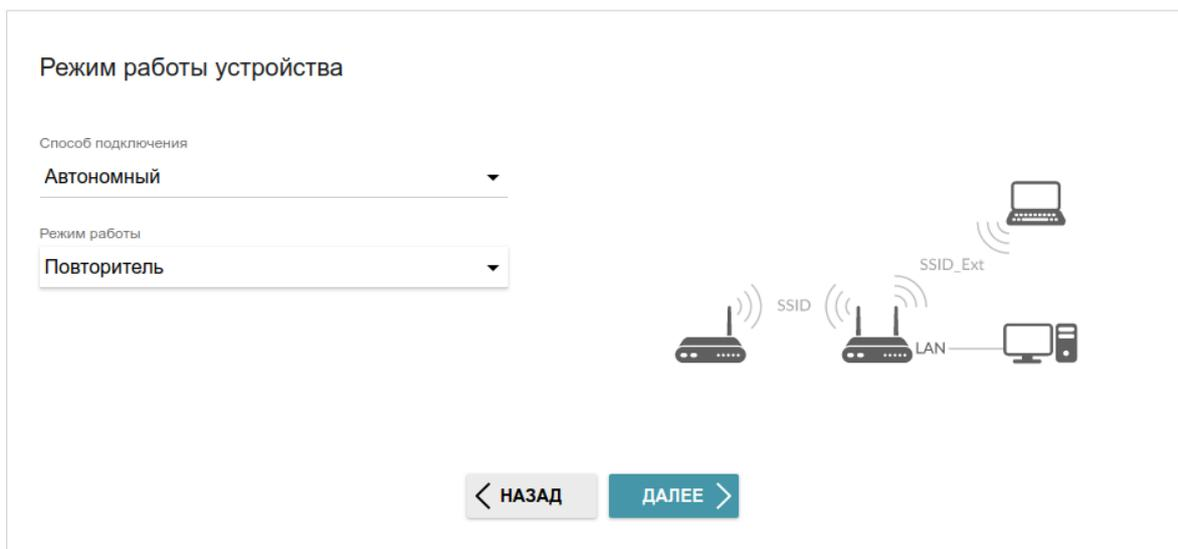
Рисунок 39. Выбор режима работы устройства. Режим **Повторитель**.
