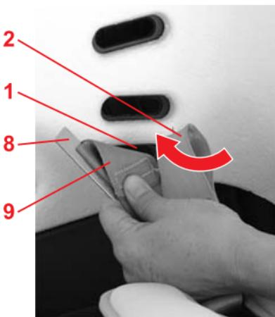
⇨ Вставьте металлическую пластинку **8** плечевой прокладки **9** через пазы для ремня **1** с задней части.
