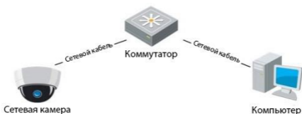
Рисунок 3-1 Подключение по LAN
