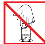
Aşırı ısınma ve yangın tehlikesini önlemek için ısıtıcının üzerini örtmeyin.
