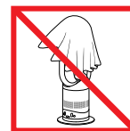
Para evitar el sobrecalentamiento y el riesgo de incendio, no cubra el calefactor.
