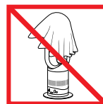
Ohřívač nezakrývejte, aby se zabránilo nebezpečí přehřátí a požáru.
