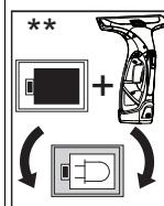
Colocar al mismo tiempo la batería de repuesto y el equipo en la estación de carga
