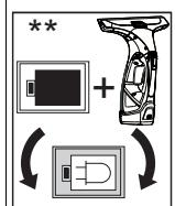
Wechselakku und Gerät gleich-zeitig in die Ladestation setzen
