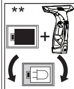
Postaviti zamenski akumulator i uređaj istovremeno u stacionarni punjač
