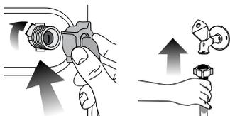
2. Затяните все гайки вручную. Не используйте для затяжки гаек гаечный ключ.
