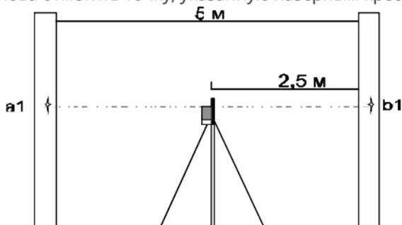
Установить лазерный построитель плоскостей на расстоянии 0,5-0,7 м от стены и нанести, как указано выше, те же отметки. Если разности  $\{a1-a2\}$  и  $\{b1-b2\}$  не отличаются друг от друга более чем на величину „точность“, заявленную в технических характеристиках, точность
