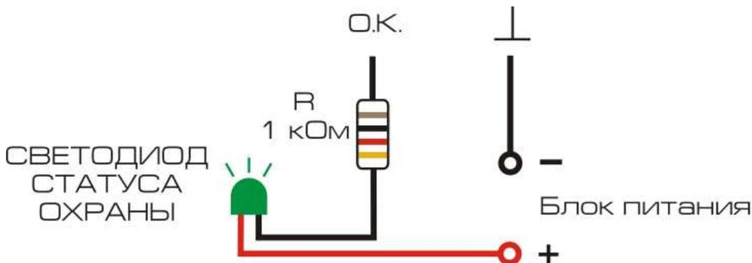
Подключите светодиод (лампу) в соответствии со схемой, представленной выше. При этом соблюдайте полярность.
