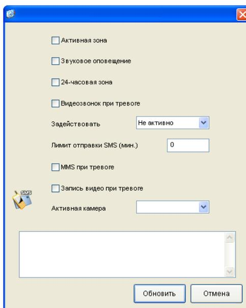
**«Активная зона»** - включает или выключает беспроводную зону.
