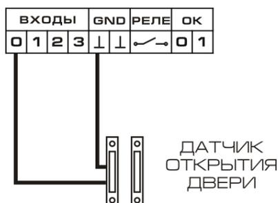
К пассивным датчикам относятся датчики которые не имеют в своем составе каких-либо электронных схем, а имеют как правило только 2 контакта. Пассивные датчики не требуют подключения питания и подключаются непосредственно к колодкам контрольной панели. При этом один контакт подключается к клеммной колодке с номером желаемой зоны, а второй к клемме обозначающей землю. К пассивным датчикам относятся всевозможные датчики открытия двери, окна, а также некоторые виды пожарных датчиков.
