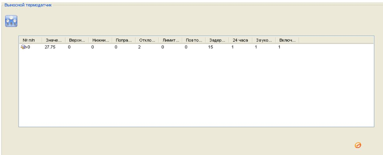
Данный пункт меню содержит настройки всех подключаемых температурных датчиков. Подключаемые датчики поддерживают измерения температуры в диапазоне -55...+125 и должны быть типа «DS18B20».
