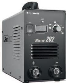
Аппараты Мастер разработаны и сделаны для профессионалов, главные особенности – мощность, надежность, компактность. Улучшенная схема стабилизации сварочного процесса дает хороший поджиг и «мягкую» сварочную дугу с минимальным разбрызгиванием. Данное устройство позволяет производить сварку постоянным током, используя инверторную технологию преобразования и управления сварочным током.
