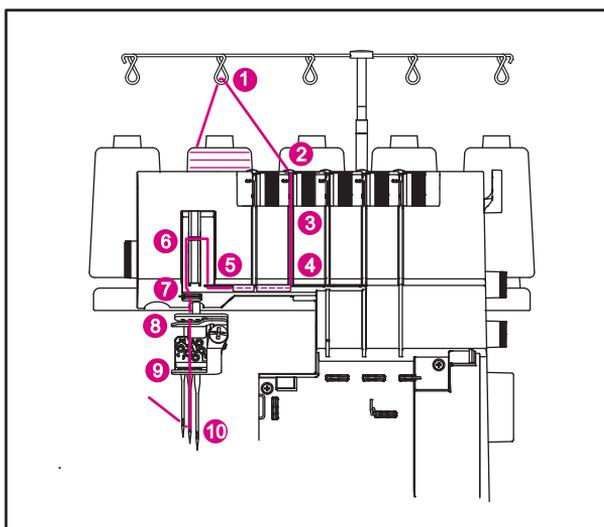
\* Поднимите прижимную лапку, чтобы освободить шайбы регулятора натяжения нити.
