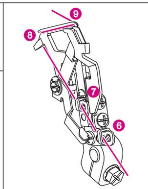
\* Заправьте ушко петлителя A от себя назад. Протяните около 10 см нити. Заведите нить в V образную выемку B на заправляющем устройстве. Твердо держите кончик нитки левой рукой и потяните рычаг заправляющего устройства C вверх в направлении D.
