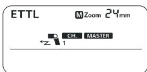
■ Даже если срабатывание ведущей вспышки отключено, на ней все равно срабатывает предварительная вспышка для передачи сигналов беспроводного управления.
