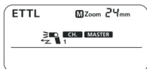
Задайте в установленной на камеру вспышке X-Flash 580 II режим ведущего устройства.
