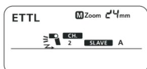
Установите остальные вспышки X-Flash 580 II в качестве ведомых устройств с беспроводным управлением.
