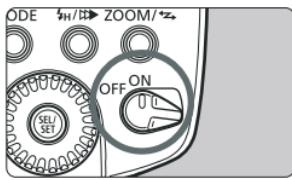
**Установите выключатель питания в положение <ON>.**
