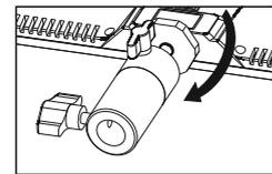
2. Установите шаровую головку на штатив и отрегулируйте угол наклона осветителя посредством регулировочного кольца на головке.
