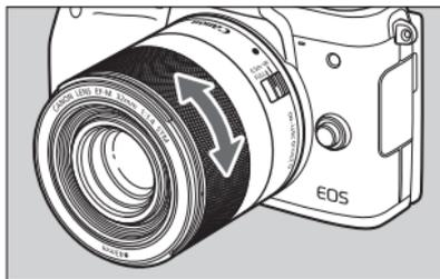
Если на камере установлен режим фокусировки [MF], настройте фокус вручную, поворачивая кольцо фокусировки.
