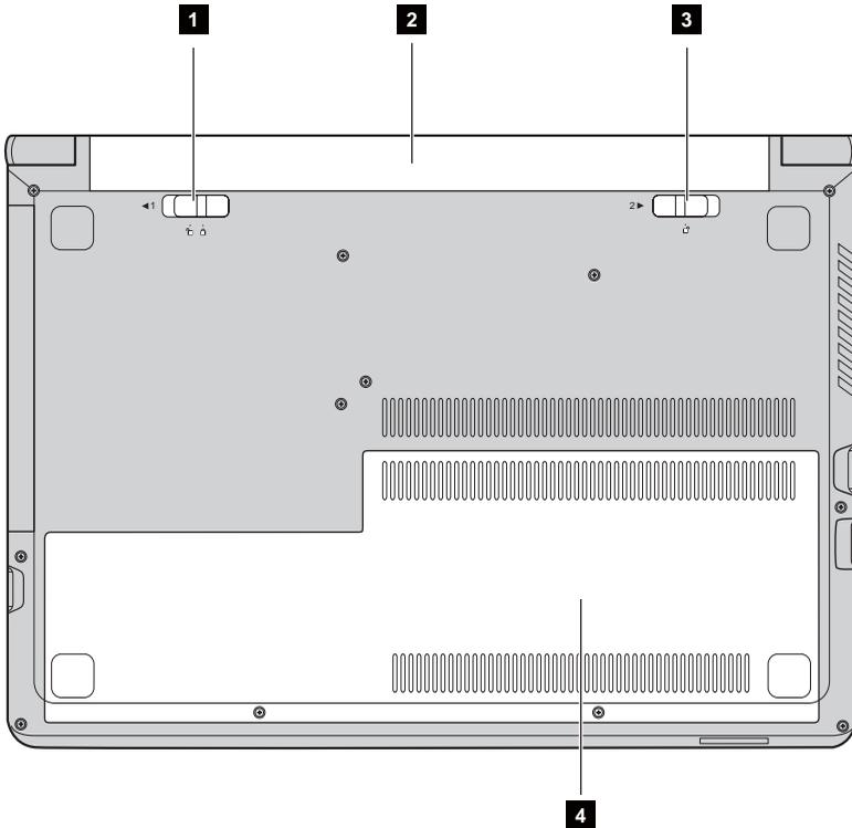
**1 Неавтоматическая защелка аккумулятора**
