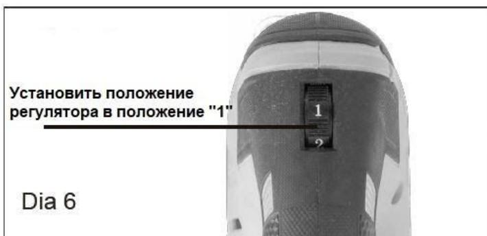
**⚠ Внимание!** Частота ходов зависит от давления на инструмент. Не перегружайте машину. При низкой частоте ходов (позиция регулировочного колеса 1 или 2) не пилите дерево, толщина которого превышает 10мм или металл, толщиной более 1мм.
