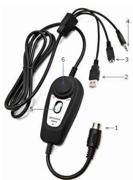
1. Разъем подключения пульта к накидке 2. USB штекер 3. Гнездо для наушников или колонок 4. Аудио штекер 5. Выключатель накидки 6. Регулятор интенсивности вибрации при работе накидки от звука
