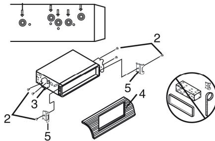
1. Выберите такое положение, в котором отверстия для винтов на кронштейне (3) будут совмещены с отверстиями для винтов на корпусе устройства и вкрутите два винта (2) с каждой стороны.
