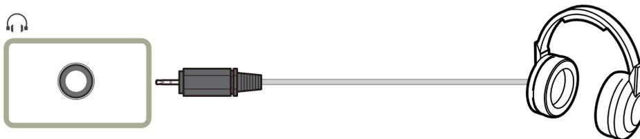
— Используйте наушники при активации звука с помощью кабеля D-SUB + AUDIO, HDMI-DVI + AUDIO, HDMI-HDMI или DP.
