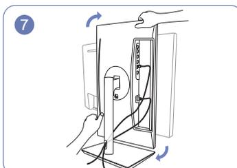
Поверните устройство в горизонтальное положение.
