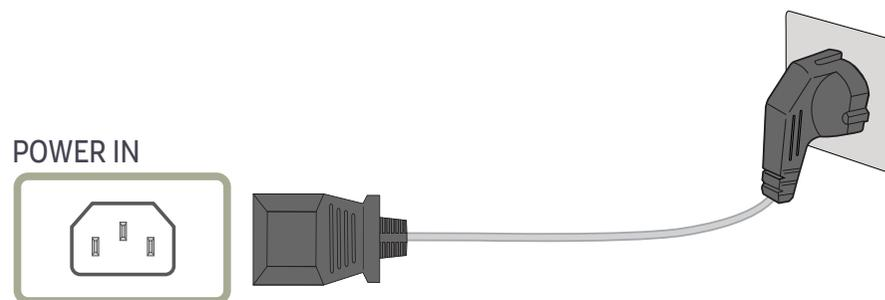
Чтобы начать использование устройства, подключите кабель питания к розетке и порту POWER IN на изделии.
