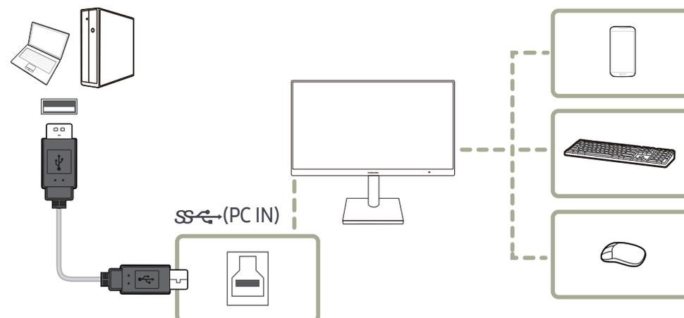
Если к ПК подключаются несколько источников сигналов, множество кабелей вокруг ПК создают беспорядок. Подключение устройств непосредственно к изделию устранил это неудобство.
