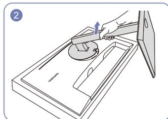
Поднимите соединительный элемент подставки в направлении, указанном стрелкой, чтобы снять его с дисплея.
