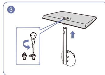
Открутите соединительный винт в нижней части подставки и снимите соединительный элемент с подставки, потянув его в направлении, указанном стрелкой, как показано на рисунке.
