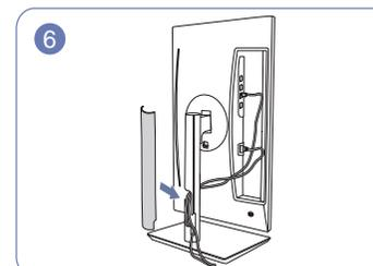
Закройте КРЫШКУ СОЕДИНИТЕЛЬНОЙ ДЕТАЛИ.
