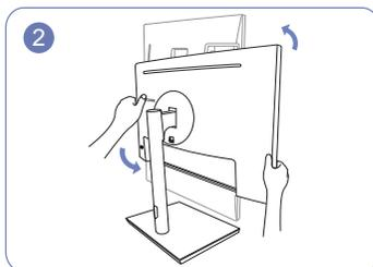
Поверните устройство в самое верхнее вертикальное положение.
