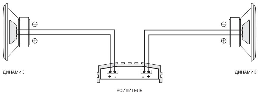
B) Схема подключения компонентных динамиков.
