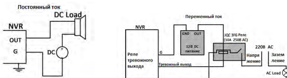
Рисунок 2.11 Подключение тревожного выхода
