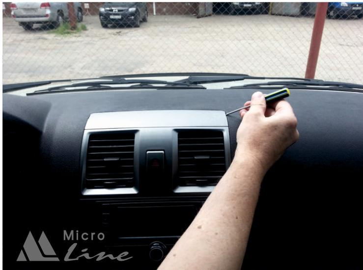
2. Снимаем облицовку щитка приборов, отвернув два винта крепления.
