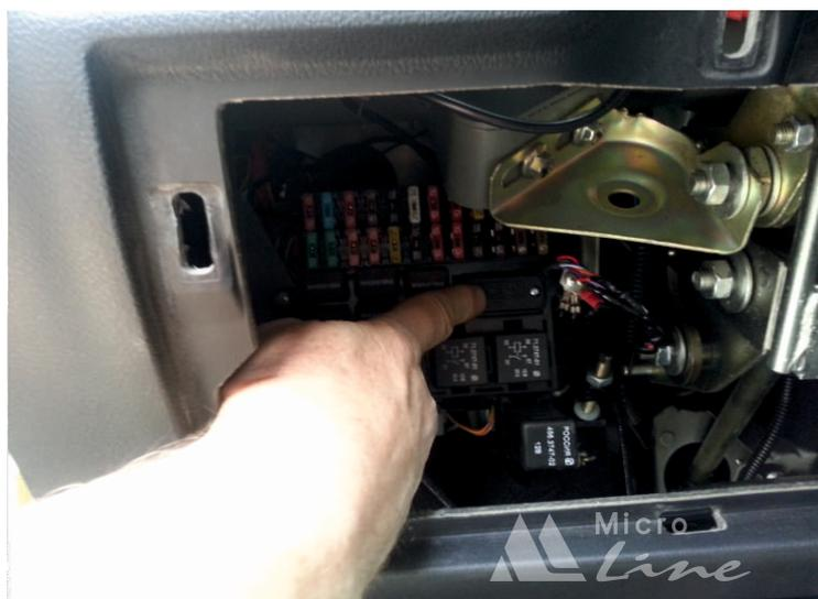
6. Снимаем крышку с блока предохранителей, который расположен под рулевой колонкой, слева и протягиваем к диагностическому разъёму автомобиля три провода монтажного жгута: черный, красный и коричневый.
