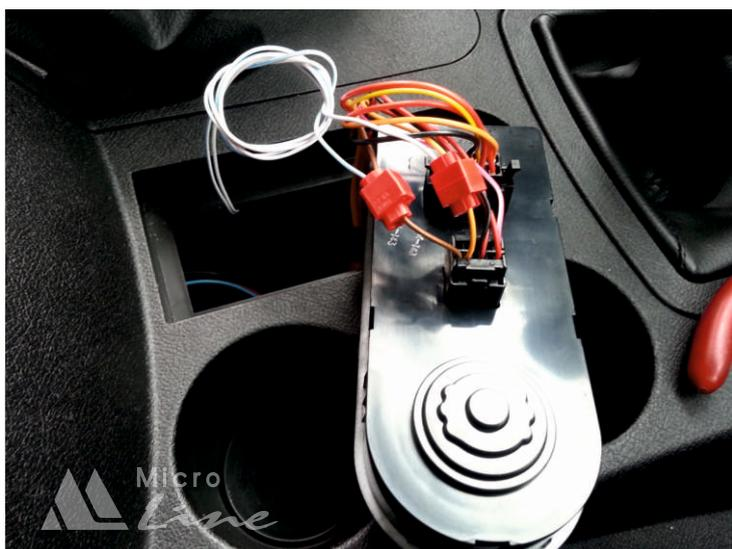
9. Протягиваем желтый с коричневой полосой и белый провода монтажного жгута к блоку подогрева сидений и переключателя топливных баков и соединяем их в следующей последовательности: белый провод жгута – оранжевый провод переключателя датчиков указателя уровня топлива (правый бак); желтый с коричневой полосой провод жгута – коричневый провод переключателя датчиков указателя уровня топлива (левый бак).
