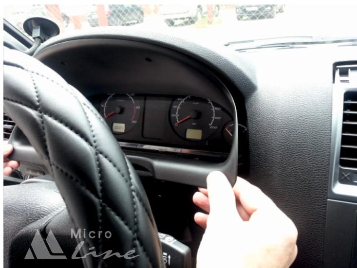
3. Снимаем щиток приборов
