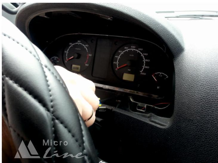
4. Прокладываем монтажный жгут из комплекта поставки от места установки бортового компьютера к приборному щитку.
