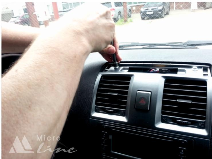
11. Подключаем разъем монтажного жгута к разъему бортового компьютера.
