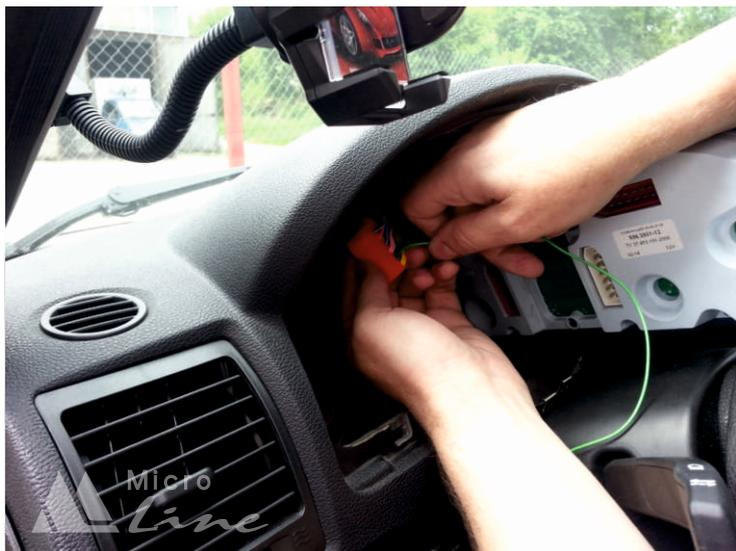
5. Подсоединяем провода монтажного жгута к проводам разъёмов щитка приборов в следующей последовательности:
