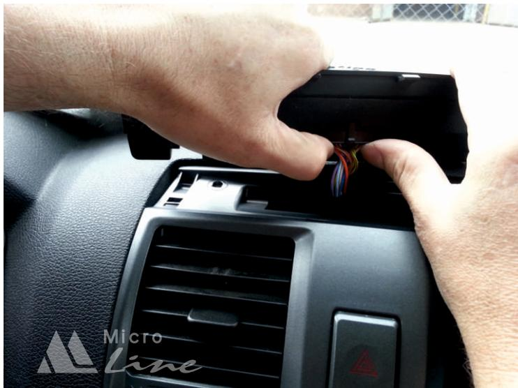
12. Подключаем диагностическую вилку к разъёму диагностики автомобиля и закрываем крышку блока предохранителей. Дисплей бортового компьютера при этом должен засветиться.
