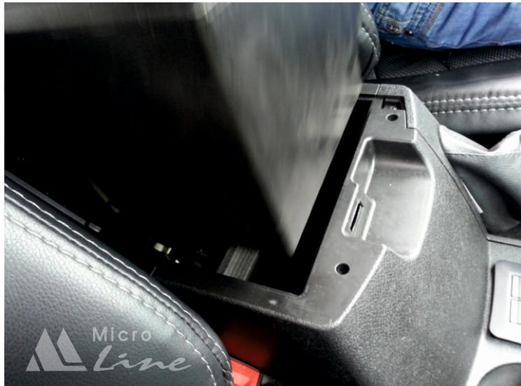
8. Надавливаем рукой снизу на блок подогрева сидений и переключателя топливных баков и снимаем его.
