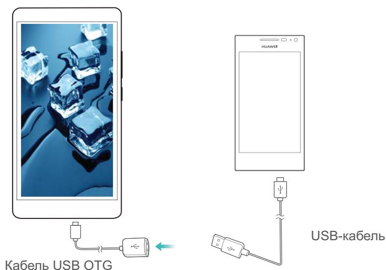
**2** На подключаемом устройстве в качестве режима USB-соединения выберите режим USB-накопителя или **Диспетчер файлов (MTP)**.
