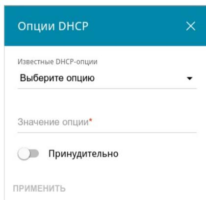
Рисунок 81. Настройка локального интерфейса. Вкладка IPv4. Окно для настройки опции DHCP.
