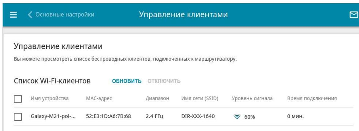
Рисунок 93. Страница для управления подключенными беспроводными устройствами.
