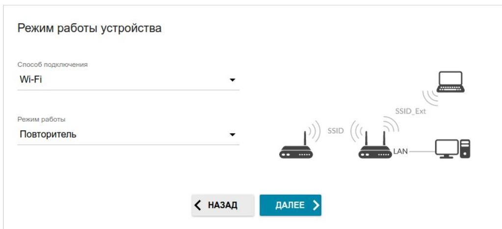
Рисунок 36. Выбор режима работы устройства. Режим **Повторитель**.
