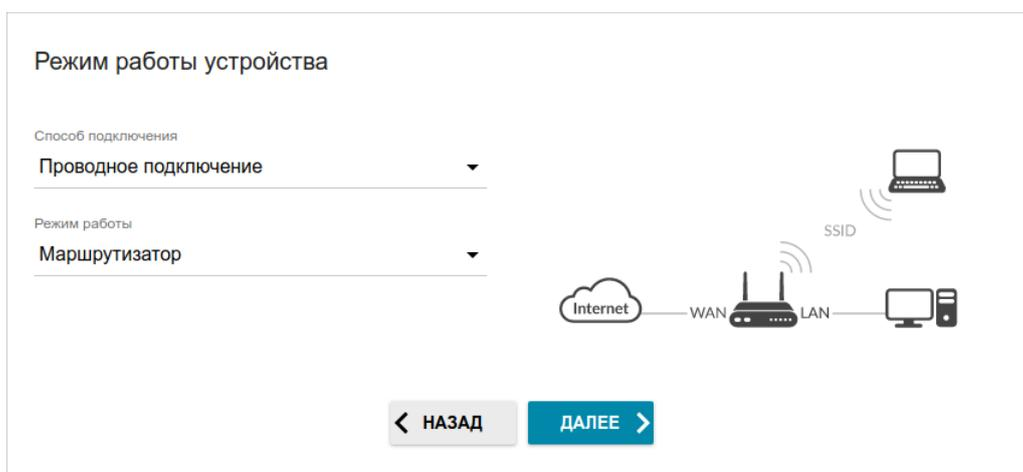
Рисунок 33. Выбор режима работы устройства. Режим **Маршрутизатор**.
