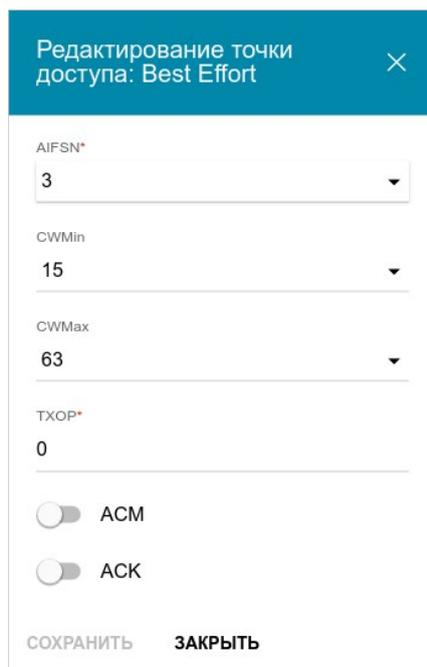
Рисунок 96. Окно для изменения параметров функции WMM.
