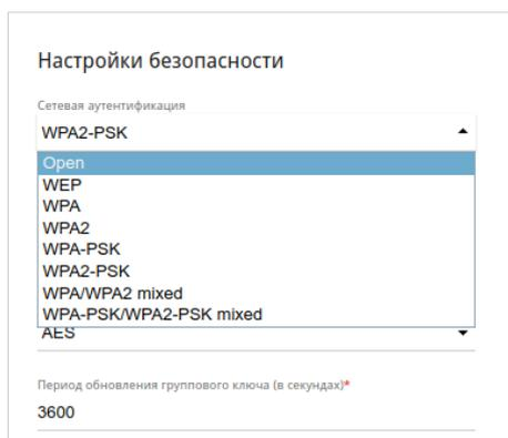
Рисунок 89. Типы аутентификации, поддерживаемые маршрутизатором.
