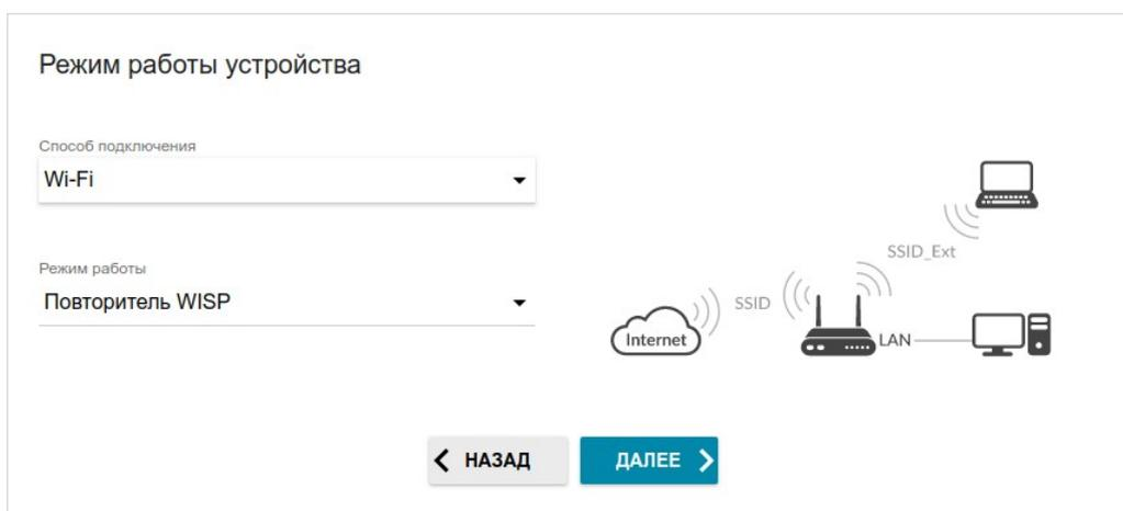
Рисунок 34. Выбор режима работы устройства. Режим **Повторитель WISP**.
