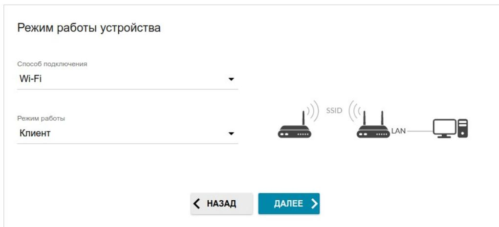
Рисунок 37. Выбор режима работы устройства. Режим **Клиент**.
