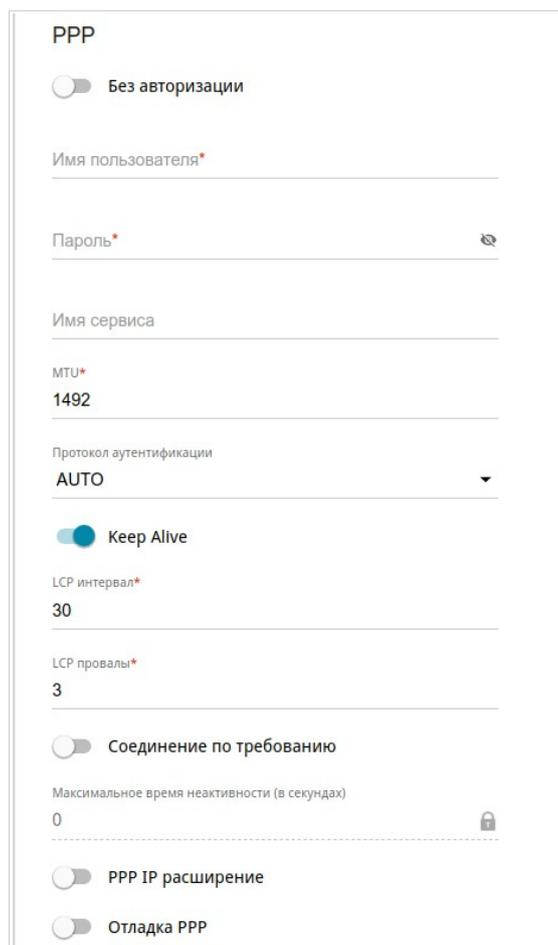
Рисунок 71. Страница добавления соединения типа **PPPoE**. Раздел **PPP**.
