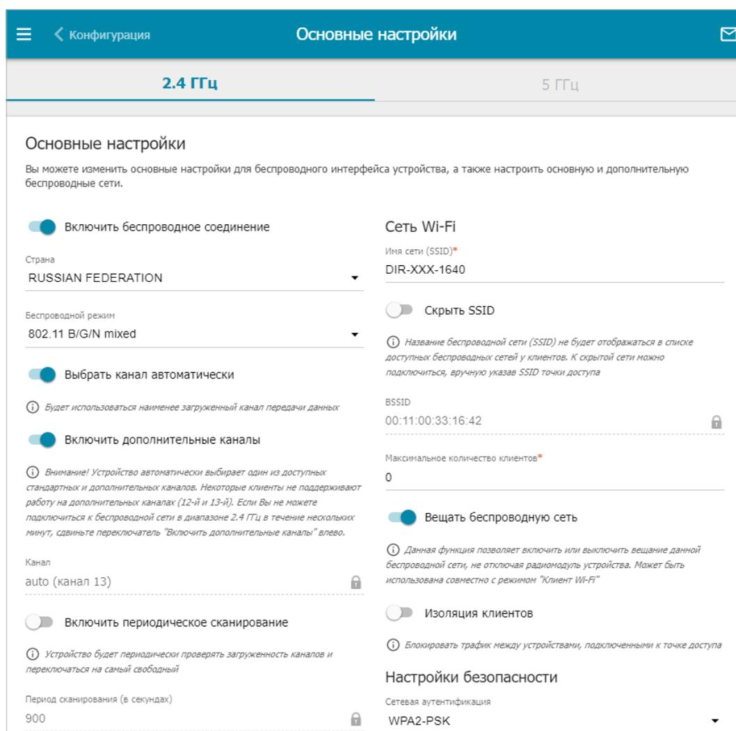
Рисунок 87. Общие настройки беспроводного соединения в диапазоне 2,4 ГГц.
