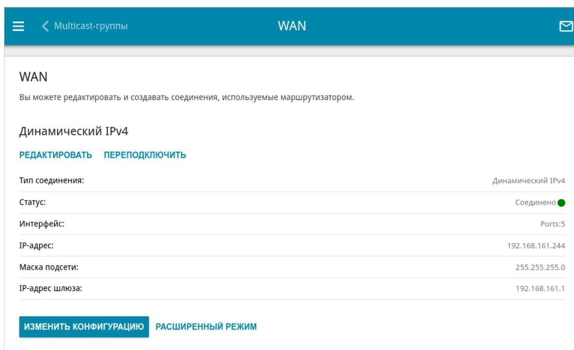
Рисунок 60. Страница **Настройка соединений / WAN**. Упрощенный режим.
