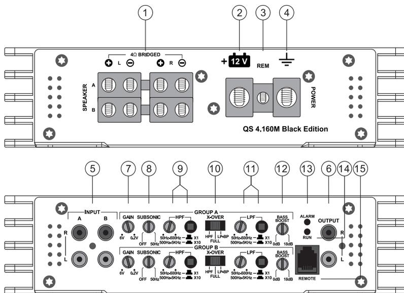
1. SPEAKER – Клеммы выхода усилителя для подключения динамиков
