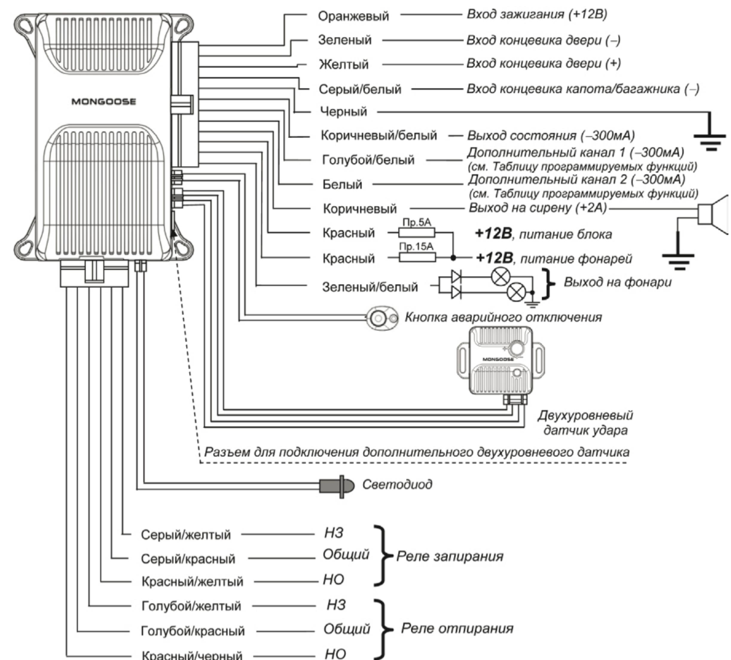
**Назначение проводов и разъемов центрального блока.**
