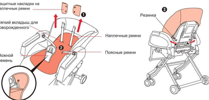
1 Снимите защитные накладки с наплечных ремней.
