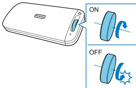
Для включения или выключения АС поворачивайте регулятор  $\phi$  по часовой стрелке или против часовой стрелки.
