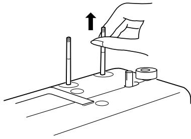
Штифты катушек предназначены для установки катушек при подаче ниток в машину.
