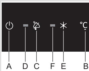
Если прибор находится в режиме ожидания (на дисплее две черточки), для включения/выключения прибора нажмите и удерживайте несколько секунд кнопку А. При первом включении предусмотрена 24-часовая отсрочка предупреждающей сигнализации о превышении допустимой температуры для предотвращения ее активации без необходимости.
