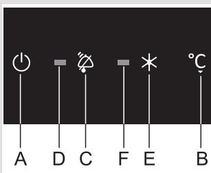
При превышении допустимой температуры включается **прерывистый звуковой сигнал**, мигает лампочка **D** и температура  $-16^{\circ}\text{C}$  на дисплее. Лампочка автоматически погаснет, когда температура в морозильнике достигнет значения, при котором нет опасности порчи продуктов.
